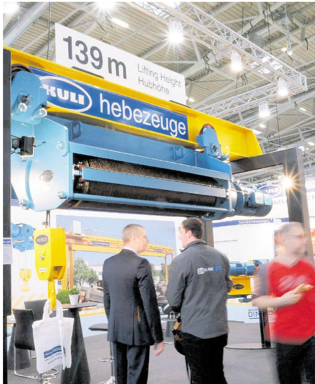
Die Einschielenkatze mit 139 Meter Hakenweg wird direkt nach „Wirtschaft erleben“ zur Fachmesse in Hannover und anschließend zum Einsatz in einem Kühlturm nach Asien transportiert. Foto: Kuli
